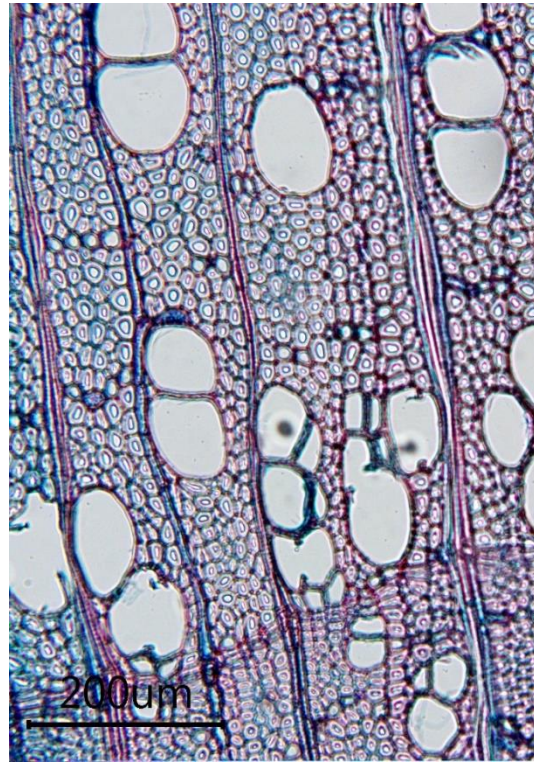
Slika 73. Poprečni presjek drva običnog graba, povećanje objektiva 10X
