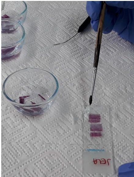
Slika 8. Prikaz slaganja drvnih presjeka (poprečnog, tangentnog i radijalnog) na predmetno stakalce
