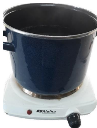
Slika 1. Prikaz omekšavanja drva kuhanjem u destiliranoj vodi
