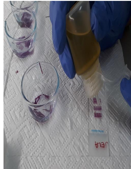
Slika 10. Prikaz uklapanja drvnih presjeka pomoću sintetskog medija Euparal
