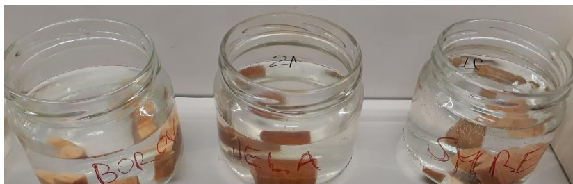
Slika 3. Prikaz uzoraka drva uronjenih u vodenu otopinu etanola
