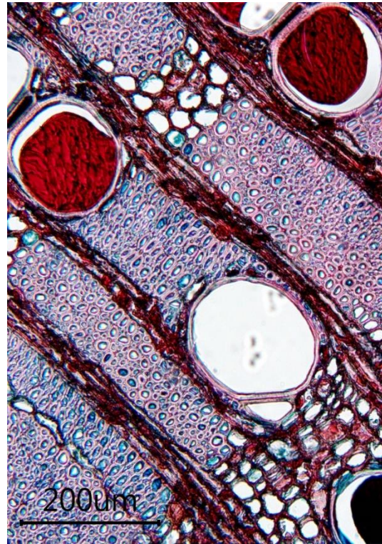
Slika 129. Poprečni presjek drva američkog mahagonija, povećanje objektiva 10X
