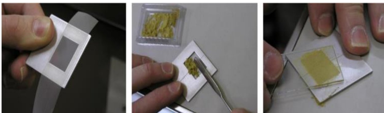
Slika 7. Postupak pripreme uzorka: a) postavljanje ljepljive trake na aluminijski nosač, b) nanošenje uzorka, c) zaravnjavanje uzorka predmetnim stakalacem.
