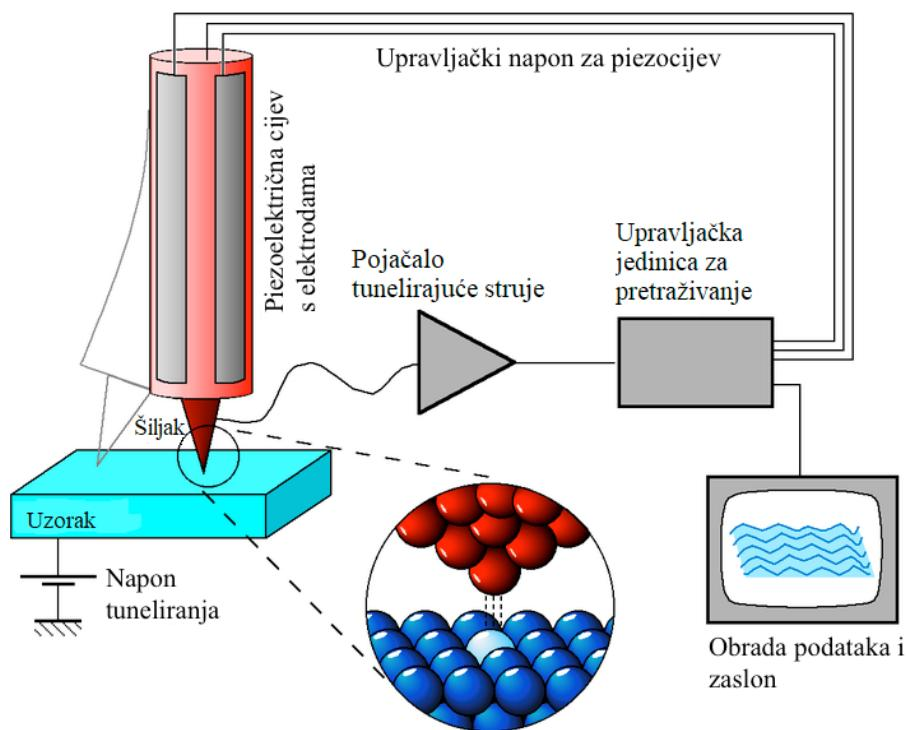
Slika 2. Shematski prikaz pretražnog tunelirajućeg mikroskopa (STM-a)
