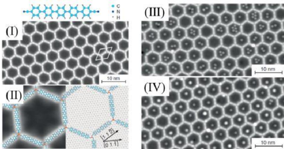
Slika 18. Primjena metalo-organskih koordiniranih nanostruktura kao kvantnih kutija. a) STM slika ( $\text{NC-Ph}_3\text{-CN})_3\text{Cu}_2$  nanoporozne mreže. b) STM slika visoke razlučivosti nanostrukture i usporedba sa strukturnim modelom. c) STM slika željezovih atoma smještenih u šupljine rešetke. d) STM slika željezovih klastera nakon zagrijavanja (preuzeto iz Q. Shen, H. Y. Gao,
