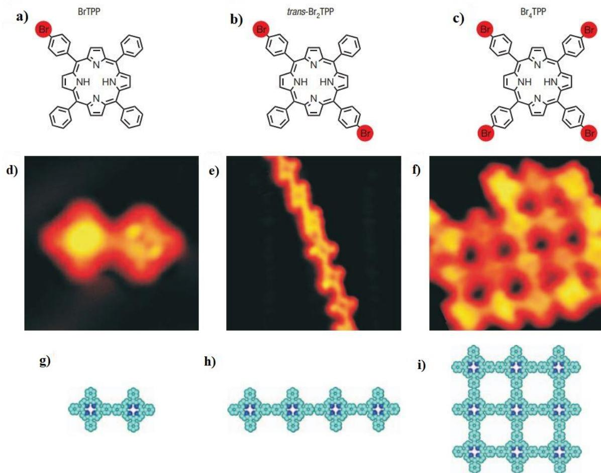
Slika 8. Ullmannova reakcija na površini Au(111) pomoću a) mono b) di i c) tetrabrom supstituiranih porfirina kao monomera; d-f) STM slike različito dimenzionalnih nanostruktura koje su produkti reakcije i g-i) njihove sheme (preuzeto iz L. Grill, M. Dyer, L. Lafferentz, M. Persson, M. V. Peters, S. Hecht, *Nat. Nanotechnol.* **2** (2007) 687–691.)
