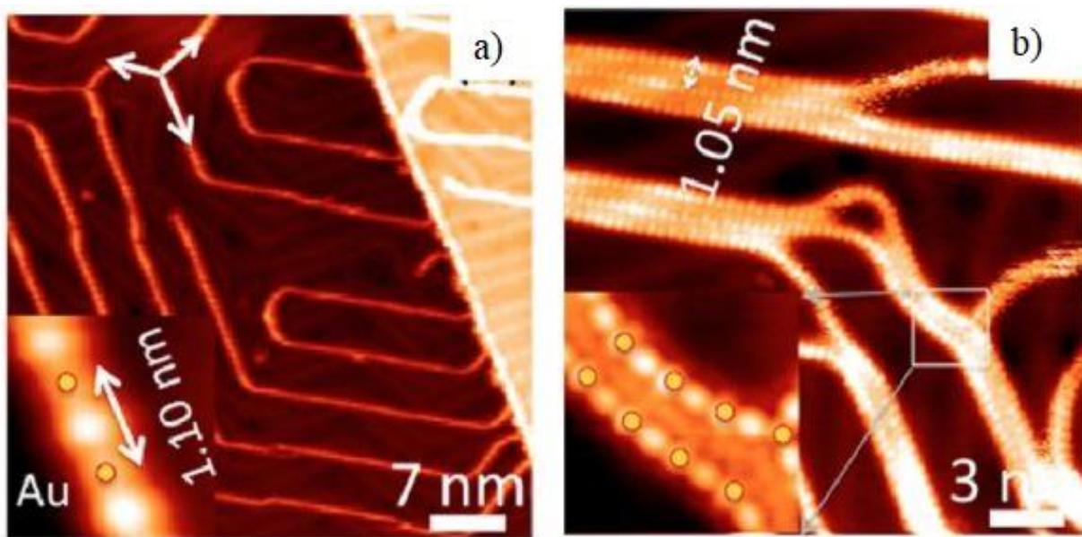
Slika 17. Primjena metalo-organskih koordiniranih nanostruktura za hvatanje ugljika. a) STM slika raspršenog Au-PDI lanca na površini Au(111). b) STM slika monoslojnih Au-PDI lanaca nakon hvatanja  $\text{CO}_2$  (preuzeto iz Q. Shen, H. Y. Gao, H. Fuchs, *Nano Today* **13** (2017) 77–96.)
