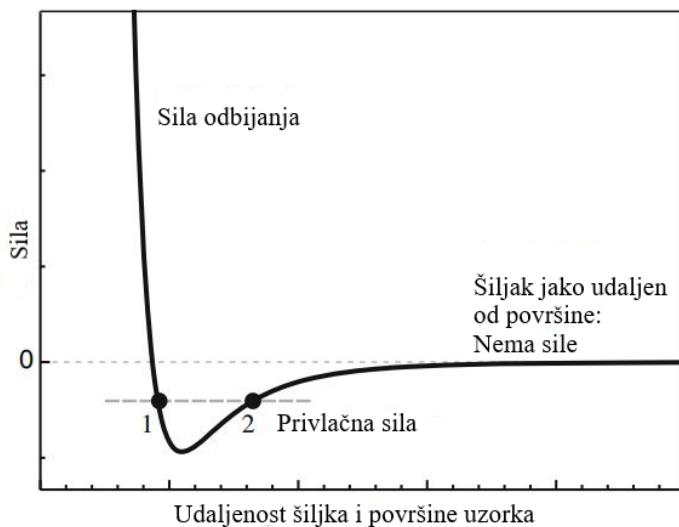
Slika 3. Djelovanje sila između šiljka i površine uzorka u ovisnosti o njihovoj međusobnoj udaljenosti opisano pomoću Lennard-Jonesovog potencijala (preuzeto iz B. Voigtländer, *Scanning Probe Microscopy*, Springer-Verlag, Berlin, 2015. str. 8)
