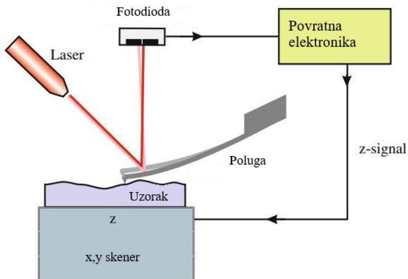
Slika 4. Shematski prikaz mikroskopa atomskih sila (AFM-a)
