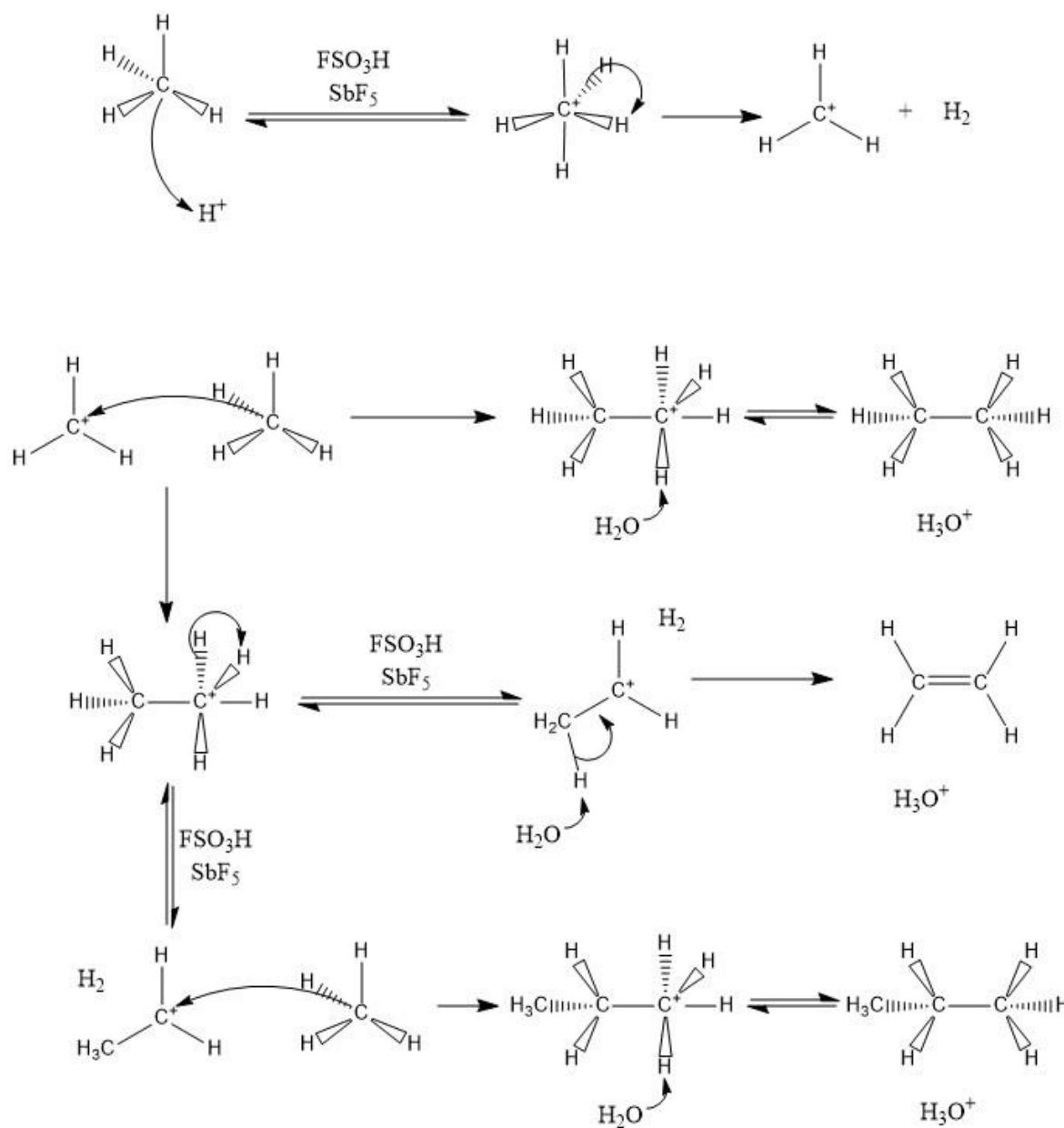
Slika 11. Mehanizam polimerizacije alkana pri čemu se nastali etani može dalje polimerizirati istim mehanizmom
