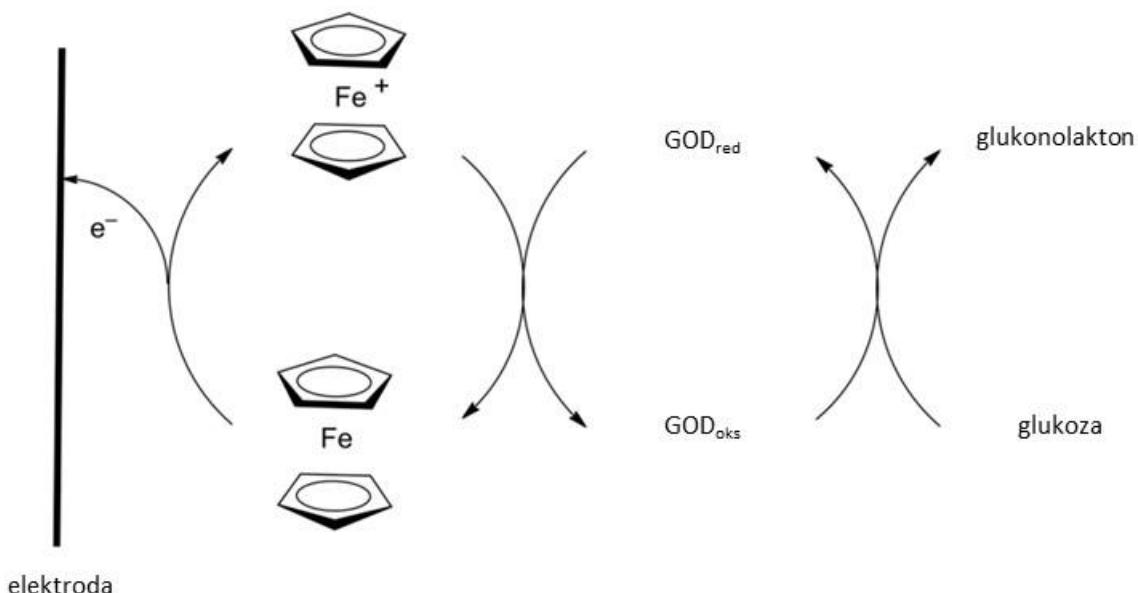
Slika 32. Anodna oksidacija glukoze do glukonolaktona uz pomoć GOD i ferocena koja je korištena kao univerzalni amperometrijski senzor za jednostavno i brzo određivanje glukoze u krvi.<sup>52</sup>
