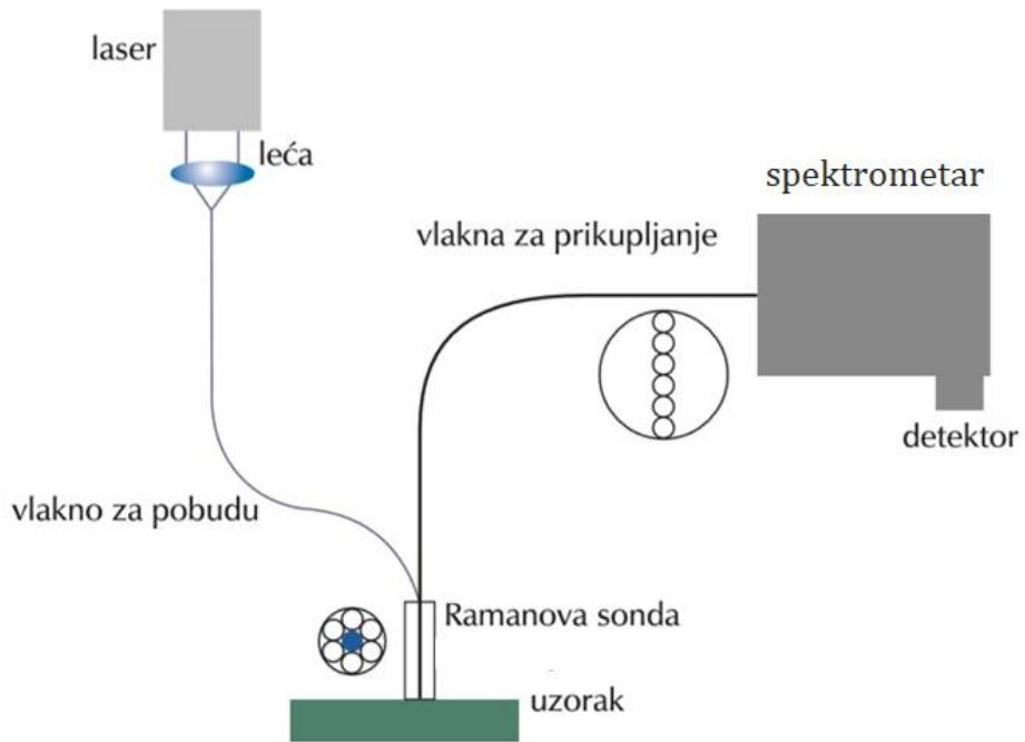
Slika 6. Ilustracija Ramanove sonde s optičkim vlaknima<sup>3</sup>
