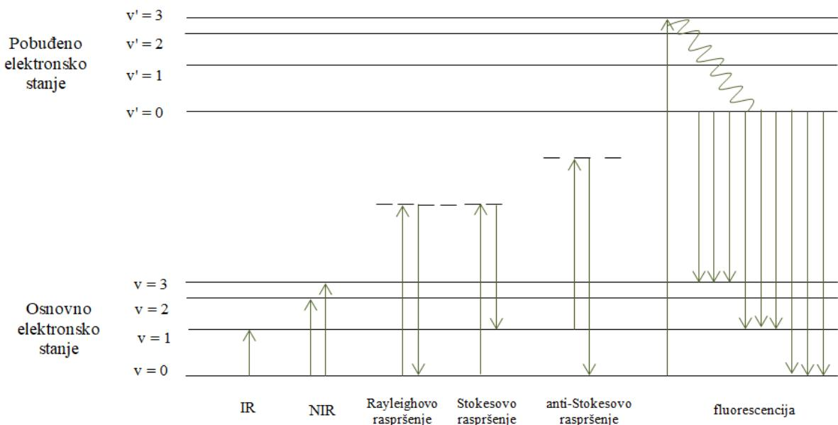
Slika 2. Shematski prikaz IR i NIR apsorbancije, Rayleighovog, Stokesovog i anti-Stokesovog raspršenja te fluorescencije
