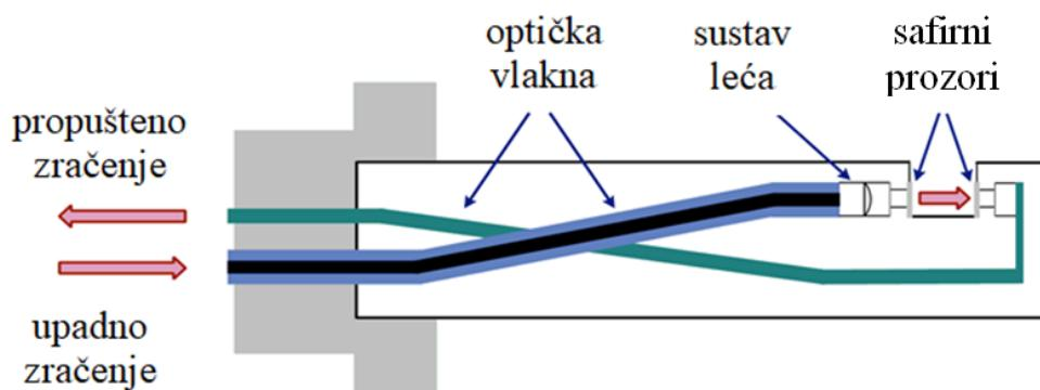
Slika 3. Presjek transmisijske NIR sonde<sup>7</sup>
