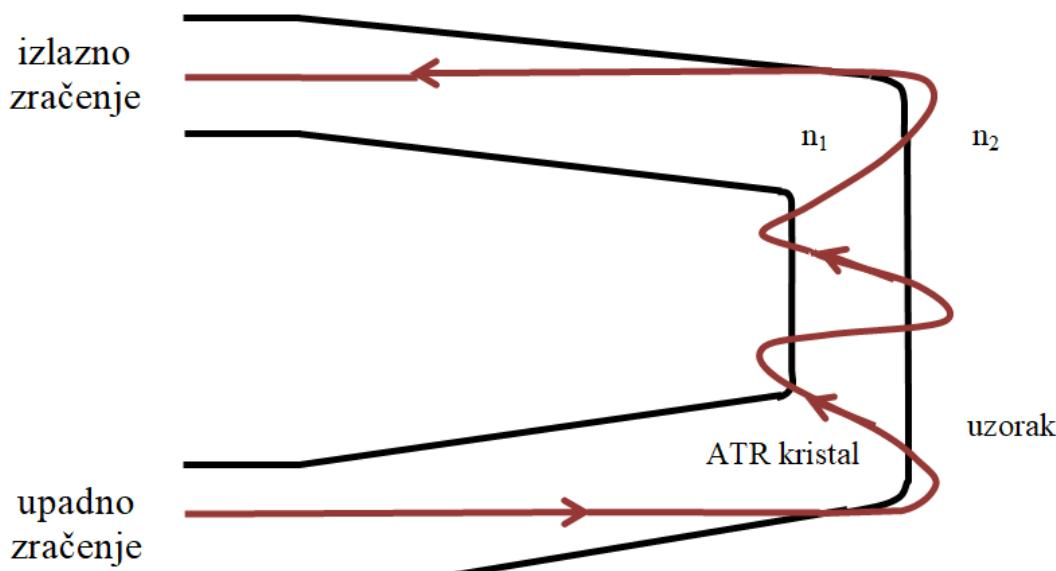
Slika 5. Shematski prikaz procesa u sondi ATR
