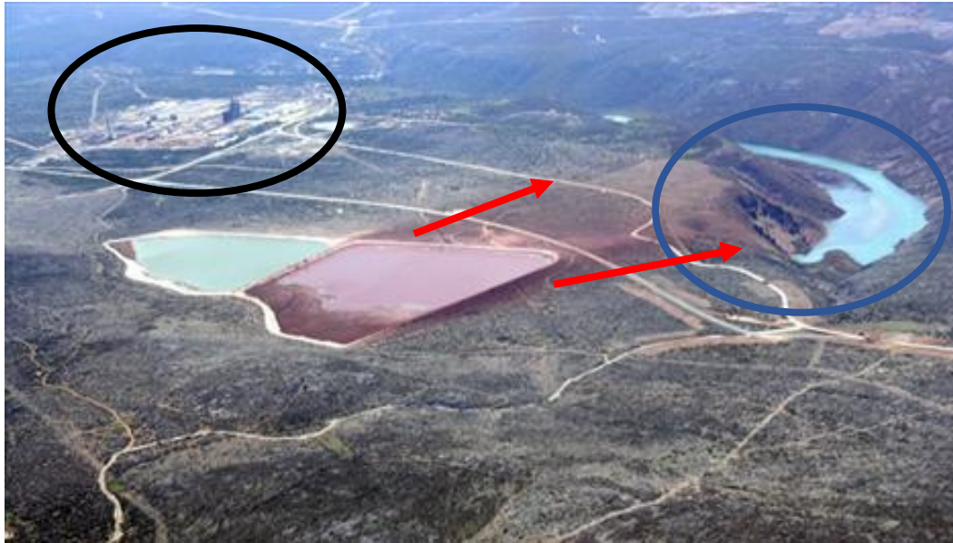
Slika 8. Bazeni s crvenim muljem (smjer širenja čestica označen crvenim strelicama) i otpadnom lužinom tvornice Jadral (označena crnom elipsom) u blizini rijeke Zrmanje (označena plavom elipsom). Prilagođeno prema URL3.
