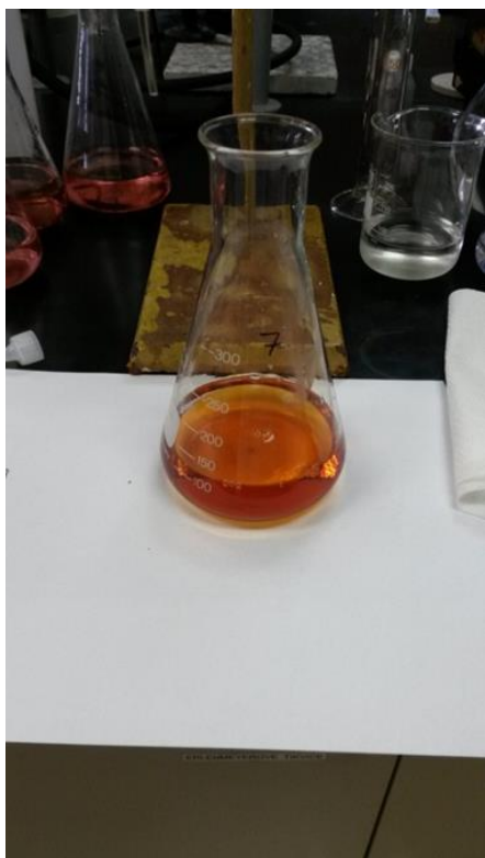
Slika 7 Opažena promjena boje po završetku titracije
