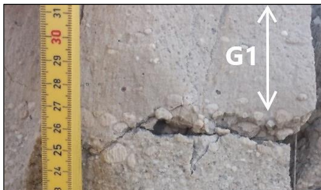
Slika 16. Facijesna asocijacija G. Laminirani kalklutit (mudstone) s valuticama po laminama i tankim proslojcima normalno graduiranog kalksiltita i vrlo sitnog pješčenjaka (facijes G1).
