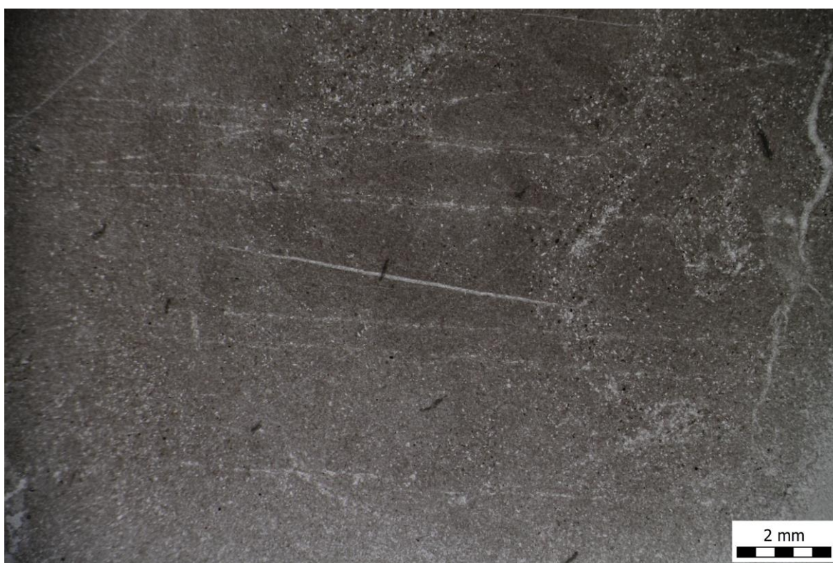
Slika 6. Mudstone mikrofacijes. Uzorak je rekristaliziran (uzorak B10, zona 3)
