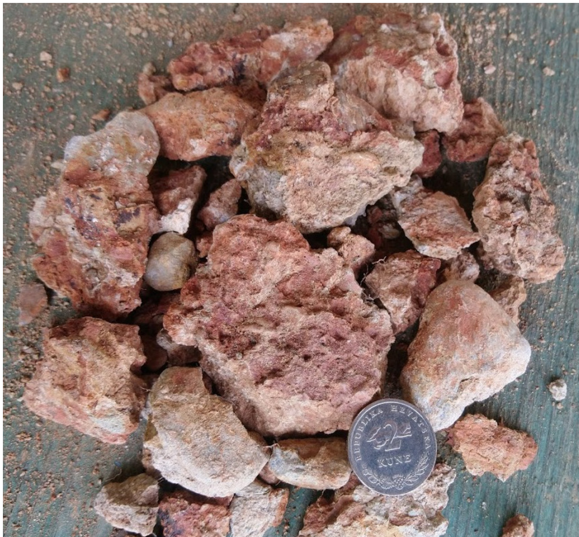
Slika 6.24. Rastresiti uzorak krupnozrnatog konglomerata (MOR3)
