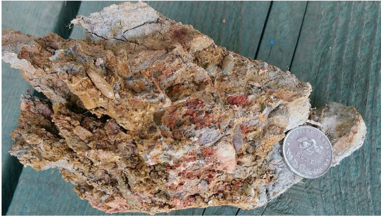
Slika 6.22. Konsolidirani uzorak sitnozrnatog konglomerata (MOR2)
