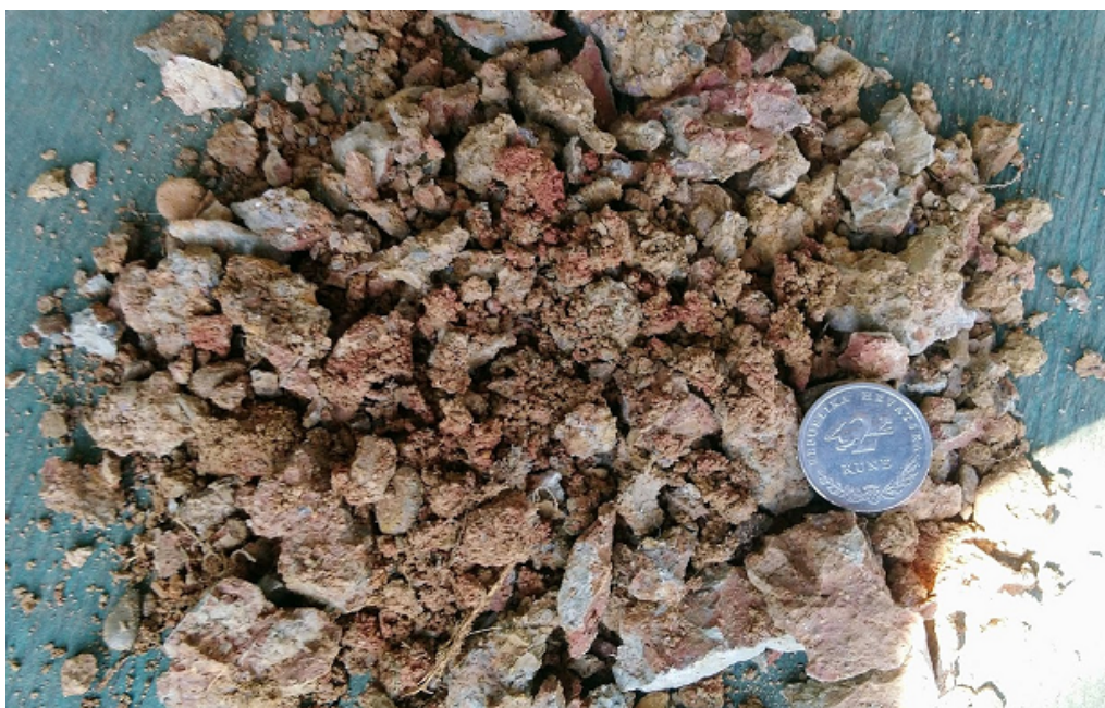
Slika 6.20. Rastresiti uzorak sitnozrnatog konglomerata (MOR1)
