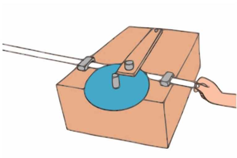
Slika 5.1: Elektromagnetsko tipkalo
