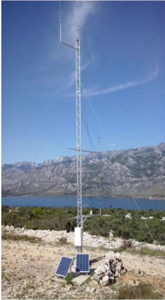
Slika 6. Lijevo: prikaz 10 m visokog tornja. Ultrazvučni anemometri nalaze se na visinama 2, 5 i 10 m. Desno: prikaz solarnih panela. U daljini je planina Velebit.
