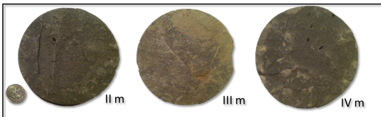
Slika 7.17. Sivi laminirani lapori iz bušotine B-2, dio jezgre 1 (II., III. i IV. metar)
