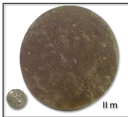
Slika 7.13. Tamnosivi siltni lapor iz bušotine B-1, dio jezgre-4, 2. metar
