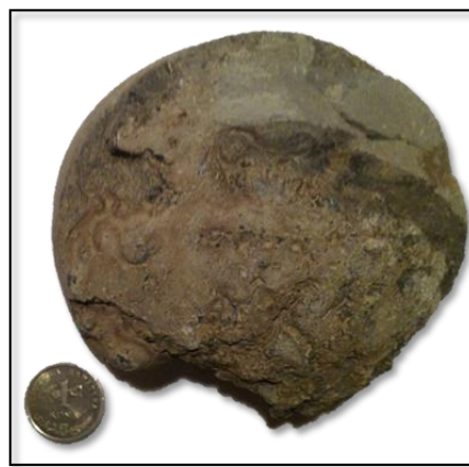
Slika 7.25. Kalcitom bogati lapor iz bušotine B-6, dio jezgre-9
