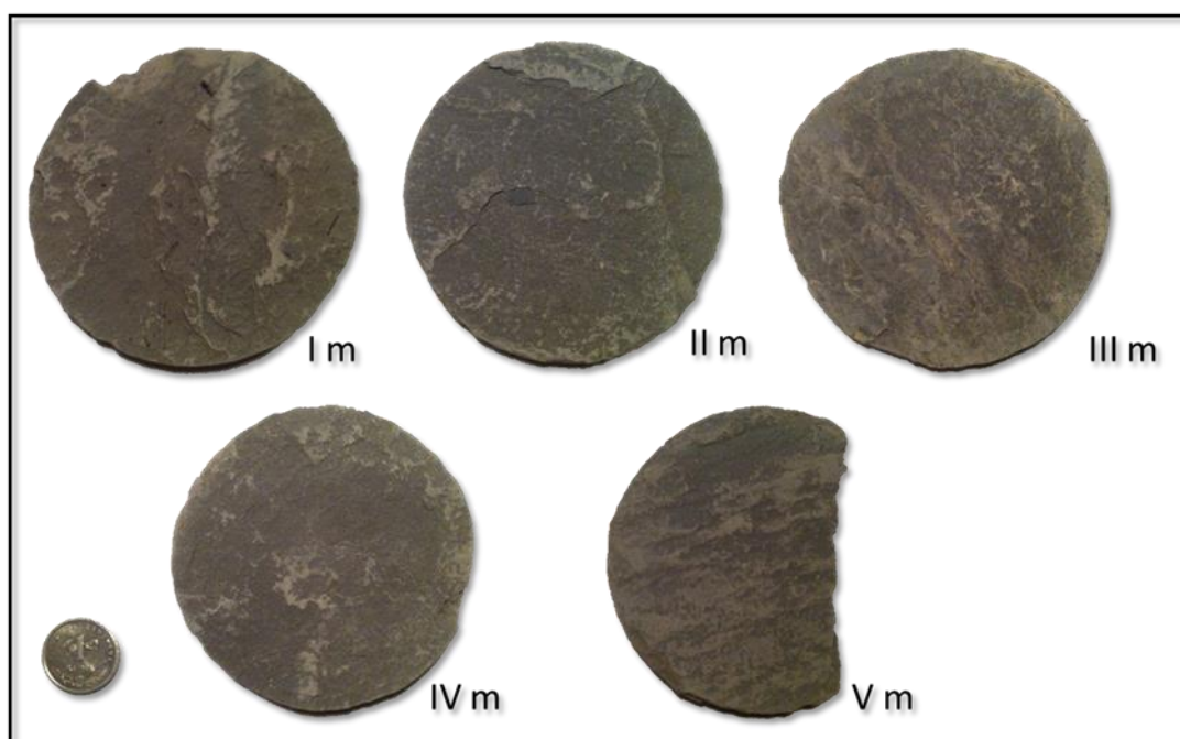
Slika 7.32. Lapor bušotine B-8, jezgra-4/I., II., III. i IV. metar
