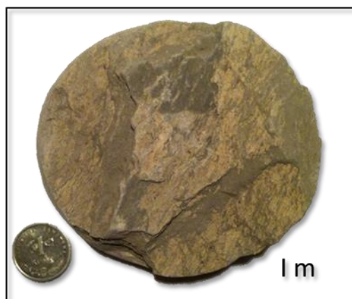
Slika 7.31. Kalcitom bogati lapor bušotine B-8, dio jezgre-3, 1. metar
