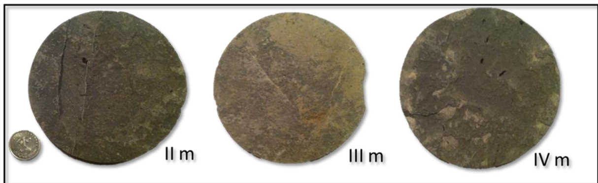
Slika 7.17. Sivi laminirani lapori iz bušotine B-2, dio jezgre 1 (II., III. i IV. metar)
