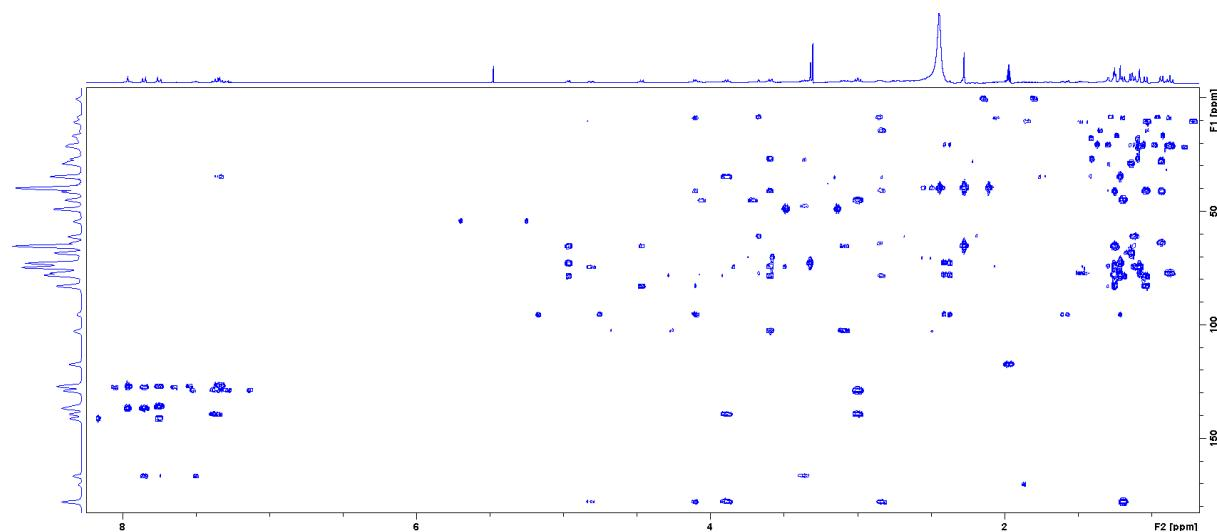
Slika D24. Spektar HMBC 2-feniletil tiosemikarbazida ( $\gamma = 5,0 \text{ mg mL}^{-1}$ ) snimljen u DMSO-
