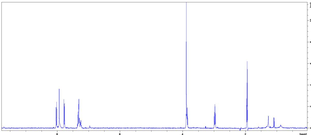
Slika D28. Spektar LC-SPE  ${}^1\text{H}$  NMR izoliranog onečišćenja Imp RRT 0,515 snimljen u acetonitrilu- $d_3$  pri  $25\text{ }^\circ\text{C}$ .
