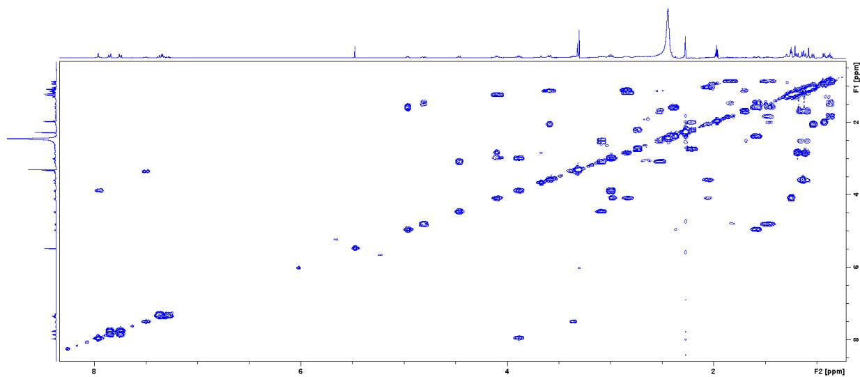
Slika D22. Spektar COSY 2-feniletil tiosemikarbazida ( $\gamma = 5,0 \text{ mg mL}^{-1}$ ) snimljen u DMSO-
