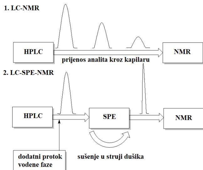
Slika 2.14. Prijenos kromatografskog pika u tehnici LC-NMR (gore) i tehnici LC-SPE-NMR (dolje).
