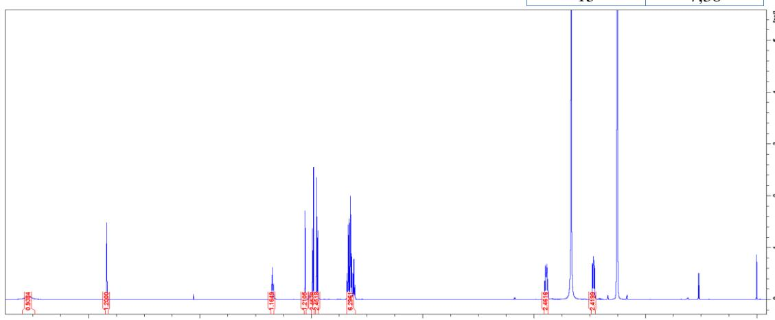
Slika D21. a) kemijska struktura; b) kemijski pomaci  $^1\text{H}$  i c) spektar  $^1\text{H}$  NMR 2-feniletil tiosemikarbazida ( $\gamma = 5,0 \text{ mg mL}^{-1}$ ) snimljen u DMSO-*d*6 pri 25 °C.
