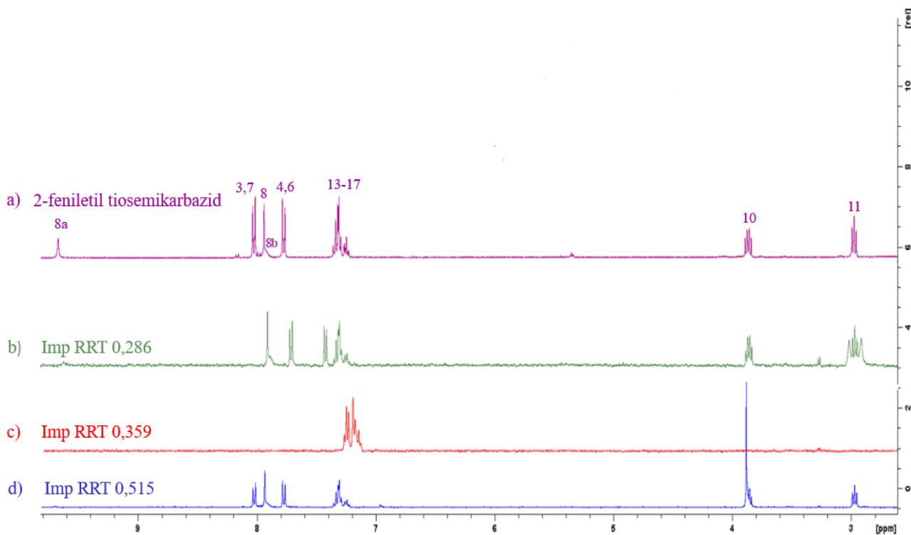
Slika 4.8. Preklopljeni spektri  $^1\text{H}$  NMR: a) 2-feniletil tiosemikarbazida; b) onečišćenja Imp RRT 0,286; c) onečišćenja Imp RRT 0,359 i d) onečišćenja Imp RRT 0,515 snimljeni u acetonitrilu- $d_3$  pri  $25^\circ\text{C}$ .
