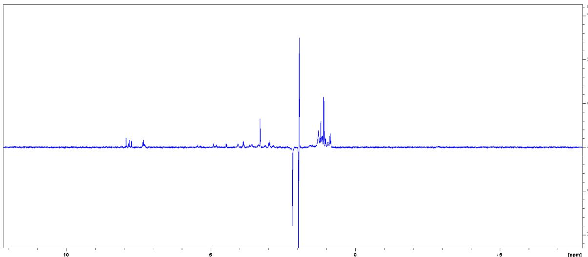
Slika D17. Spektar LC-SPE  $^1\text{H}$  NMR izoliranog 9a-(2-feniletil)makrozona snimljen u acetonitrilu-*d*3 pri  $25^\circ\text{C}$ .
