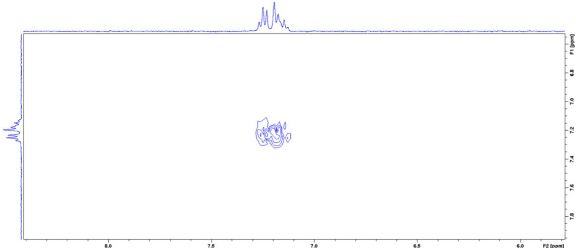
Slika D27. Spektar COSY onečišćenja Imp RRT 0,359 snimljen u acetonitrilu- $d_3$  pri 25 °C.
