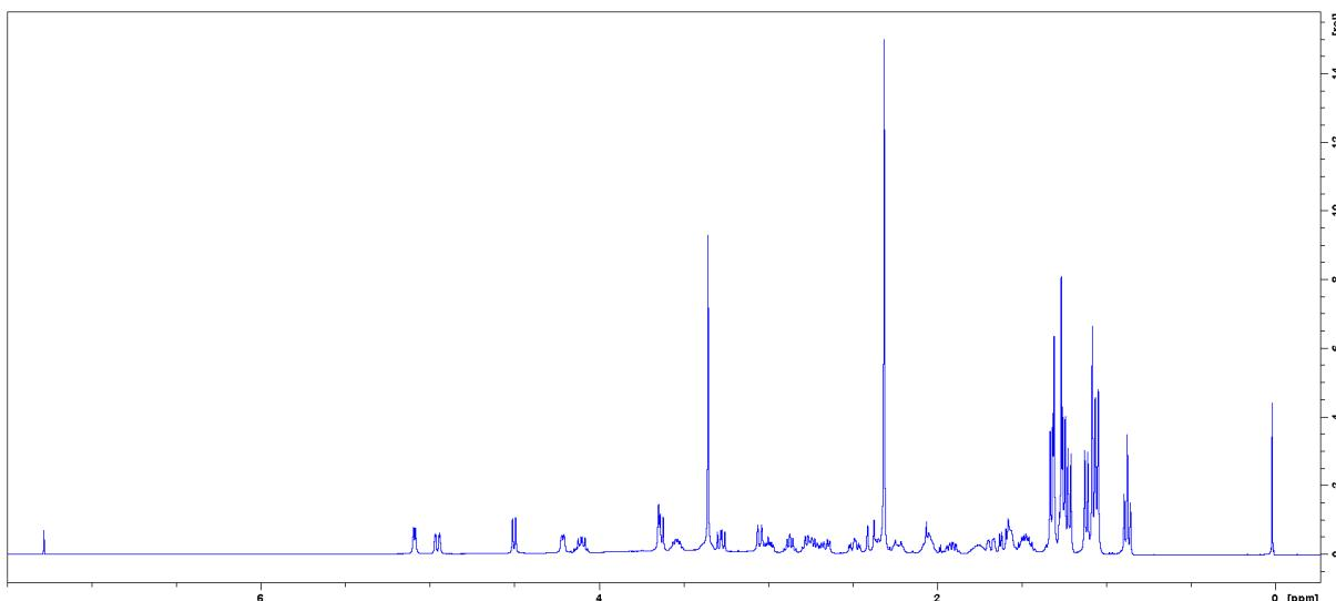
Slika D15. Spektar  $^1\text{H}$  NMR 9a-( $\gamma$ -aminopropil) derivata azitromicina ( $\gamma = 5,0 \text{ mg mL}^{-1}$ ) snimljen u acetonitrilu-*d*3 pri  $25^\circ\text{C}$ .
