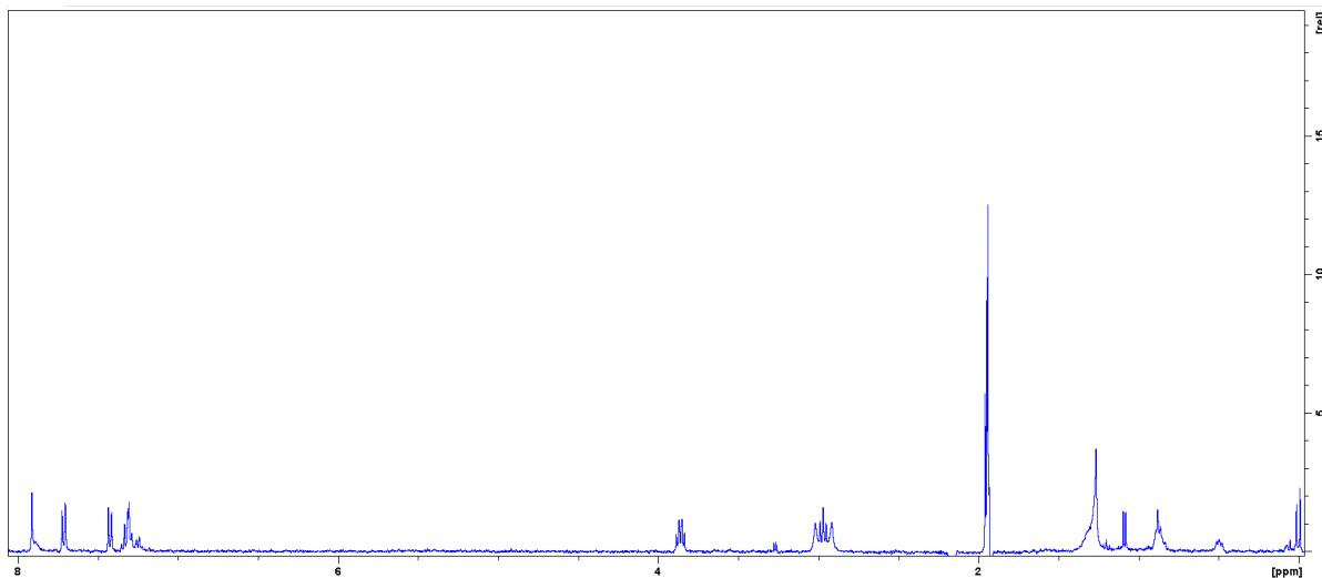
Slika D25. Spektar LC-SPE  $^1\text{H}$  NMR onečišćenja Imp RRT 0,286 snimljen u acetonitrilu- $d_3$
