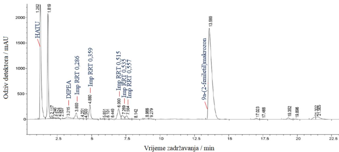
Slika 4.1. Reprezentativni kromatogram reakcijske smjese 9a-(2-feniletil)makrozona masene koncentracije  $2,0\text{ mg mL}^{-1}$ .
