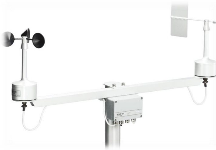
Slika 8. Anemometar Vaisala WAA151 i vjetrulja Vaisala WAV151 na stupu.
