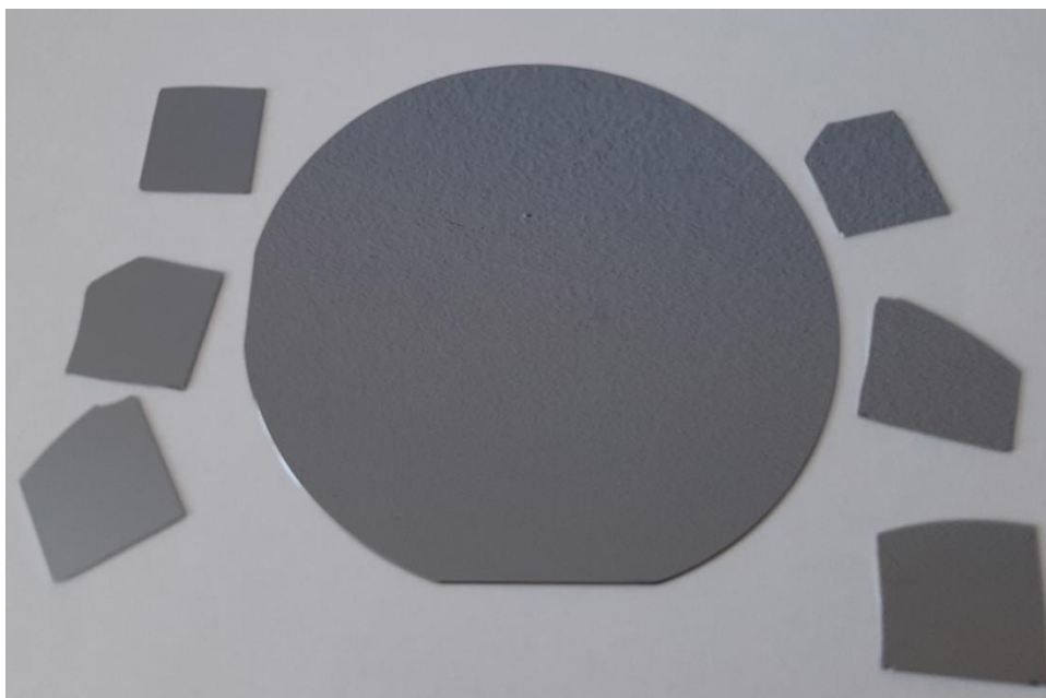
Slika 34. Silicijeva pločica i izrezani uzorci – kvadratići površine \sim 4 \text{ cm}^2 spremni za jetkanje.
