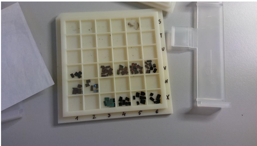
Slika 38. Način čuvanja uzoraka fotoničkih kristala od poroznog silicija izrezanih na male komadiće površine 1 do 2 \text{mm}^2 .
