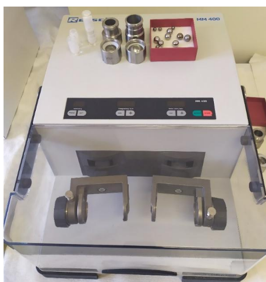
Slika 15. Vibracijski mlin, posudice i kuglice za mljevenje.
