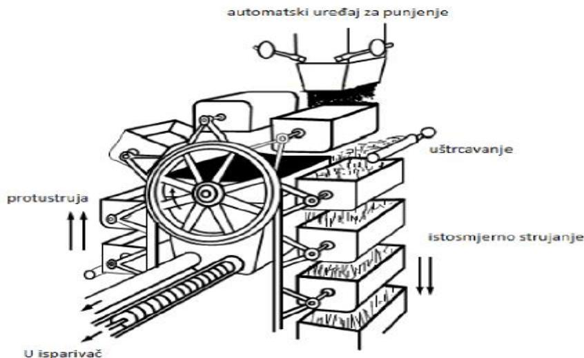
Slika 3. Shema ekstraktora po Bollmanu.<sup>3</sup>
