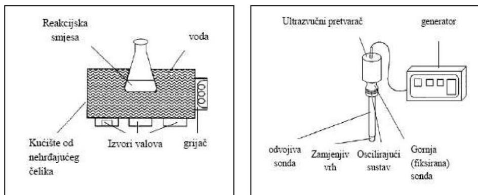
Slika 9. Shematski prikaz uređaja za ultrazvučnu ekstrakciju: a) Ultrazvučna kupelj; b) Ultrazvučna sonda.<sup>46</sup>Error! Bookmark not defined.
