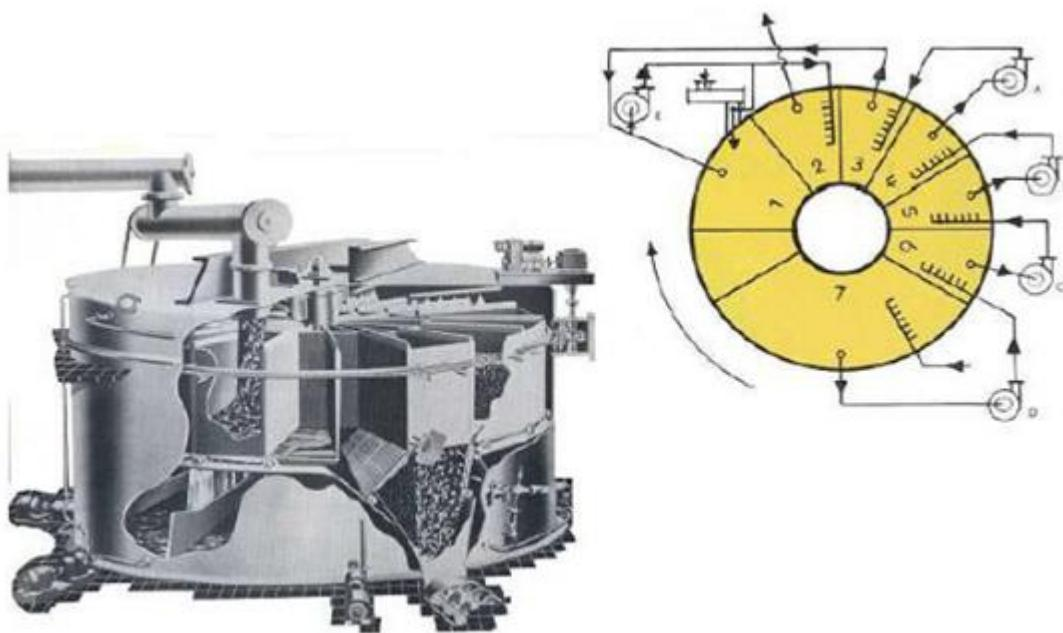
Slika 2. Shema ekstraktora „Rotocel“ za kontinuiranu ekstrakciju.<sup>3</sup>
