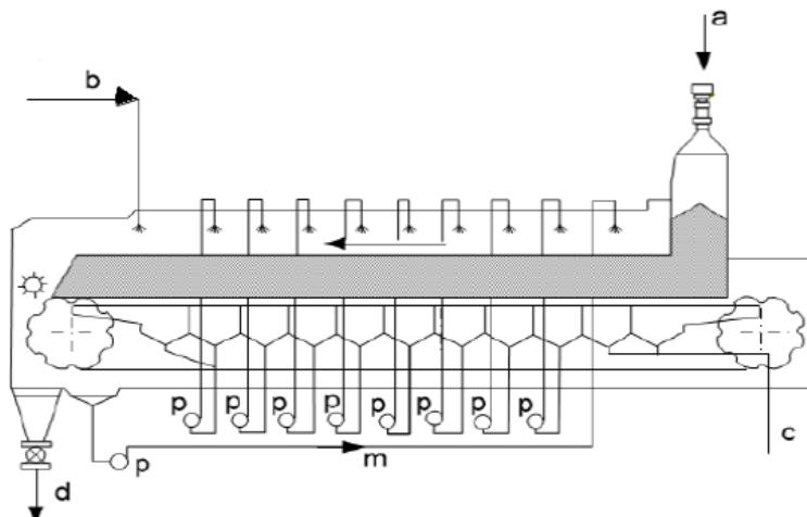
Slika 4. Shema De Smetovog ekstraktora s trakom: (a) ulaz materijala, (b) ulaz otapala, (c) izlaz miscele, (d) izlaz sačme, (p) pumpe za cirkulaciju otapala, (m) miscela, (e) žičana porozna traka.<sup>3</sup>
