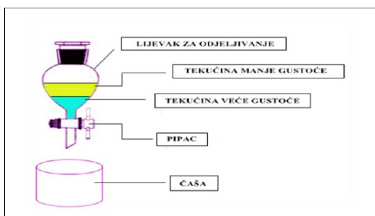
Slika 5. Lijevak za odjeljivanje.<sup>20</sup>
