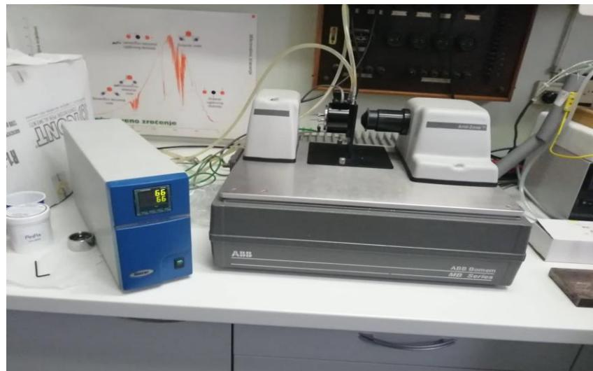
Slika 12. Korišteni IR spektometar ABB Bomem MB102 i visokotemperaturni kontroler Specac 3000 Series (fotografirano u Laboratoriju za biomolekularne interacije i spektroskopiju Zavoda za organsku kemiju i biokemiju IRB-a).
