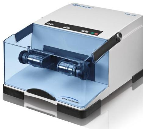
Slika 13. Kuglični mlin korišten u mehanokemijskoj sintezi.
