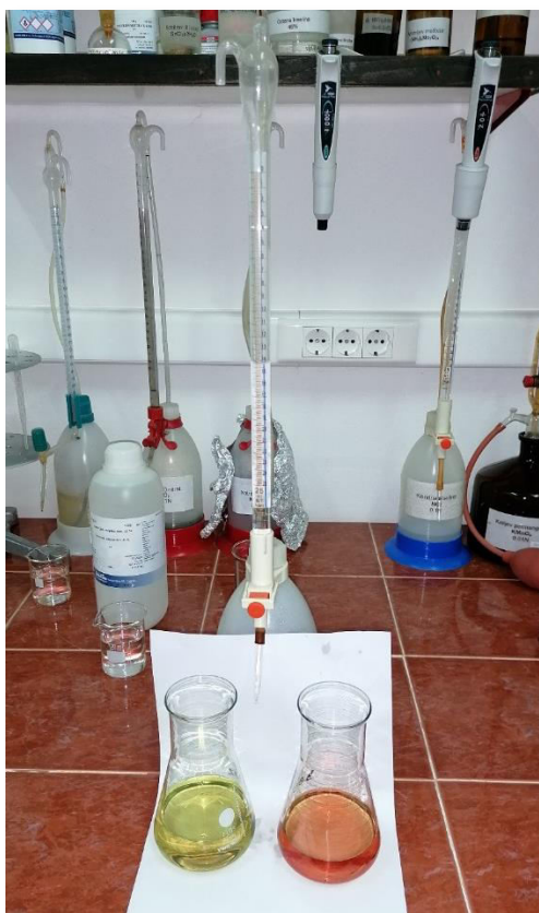
Slika 5. Promjena boje tijekom titrimetrijskog određivanja vezanog \text{CO}_2 (alkaliniteta) uz metiloranž kao indikator (foto: A.M. Širjan, 2019.)
