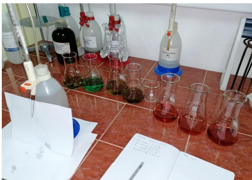
Slika 6. Uzorci vode u postupku određivanja ukupne tvrdoće u vodi kompleksometrijskom titracijom (foto: A.M. Širjan, 2019.)
