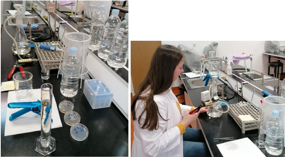
Slika 12. Pribor i metoda rada membranske filtracije s vakuumom (foto: A.M. Širjan, 2019.)
