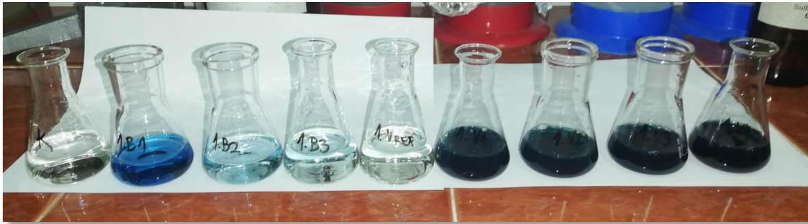
Slika 4. Uzorci vode pripremljeni za postupak spektrofotometrijskog određivanja fosfata s amonijevim molibdatom i kositrovim kloridom (foto: M. Sertić Perić, 2019)
