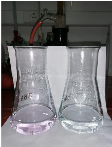
Slika 7. Promjena boje tijekom retitrimetrijskog određivanja kemijske potrošnje kisika temeljem potrošnje kalijevog permanganata ( \text{KMnO}_4 ) (foto: A.M. Širjan, 2019.)
