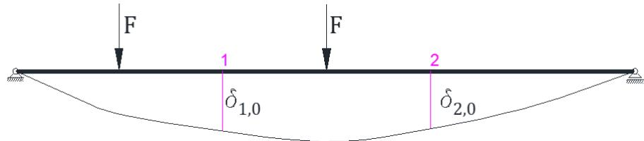
Slika 1.6: Progibna linija osnovnog sustava za vanjsko opterećenje
