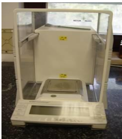
Slika 14. Analitička vaga (preuzeto s Internetski izvor 7)
