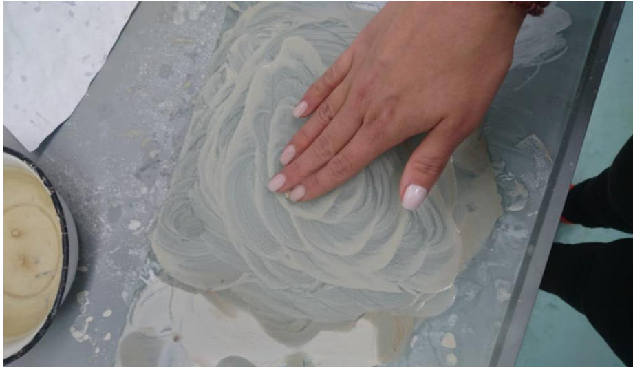
Slika 12. Poliranje preparata korundovim prahom
