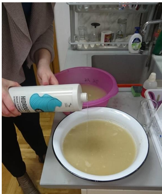
Slika 10. Dodavanje vodikovog peroksida u usitnjeni uzorak s vodom
