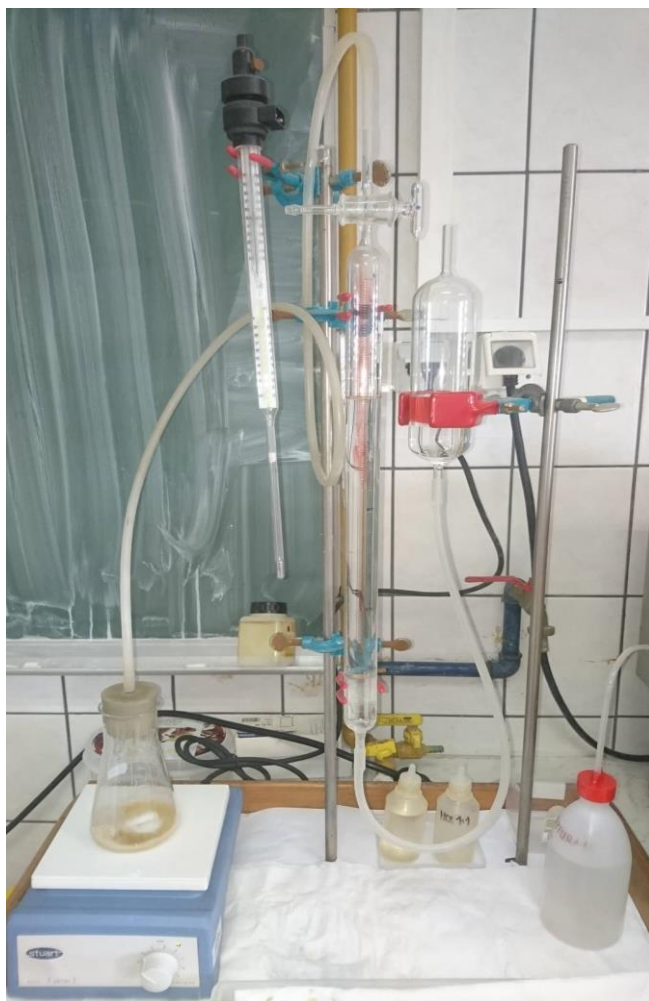
Slika 13. Scheiblerov kalkimetar u laboratoriju MPZ-a
