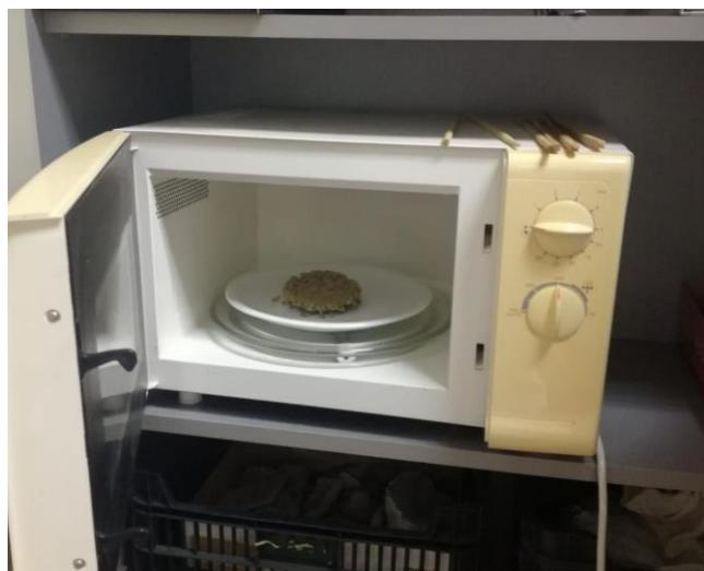
Slika 2. Postupak zagrijavanja u mikrovalnoj pećnici
