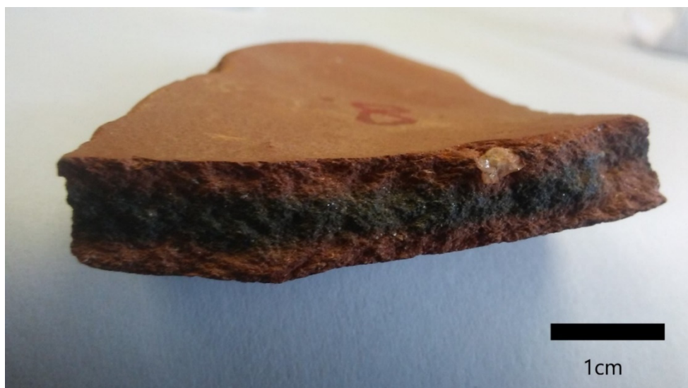
Slika 6.7. Uzorak laminiranog crijepa (B8), izdvojene su dvije faze, crna i crvena; Brazil, Parelhas
