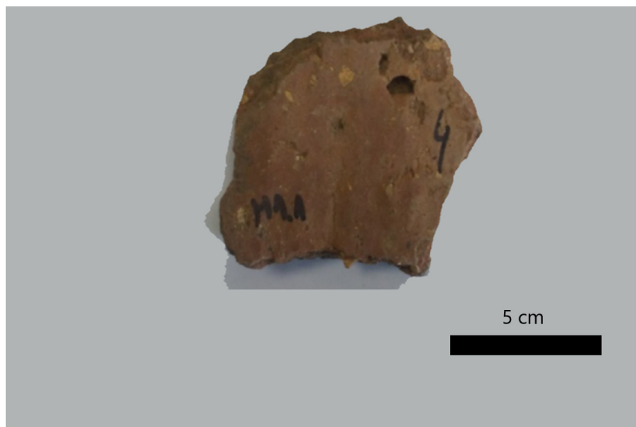
Slika 6.1. Uzorak opeke s porama (M1.1). Makedonija, Alinci
