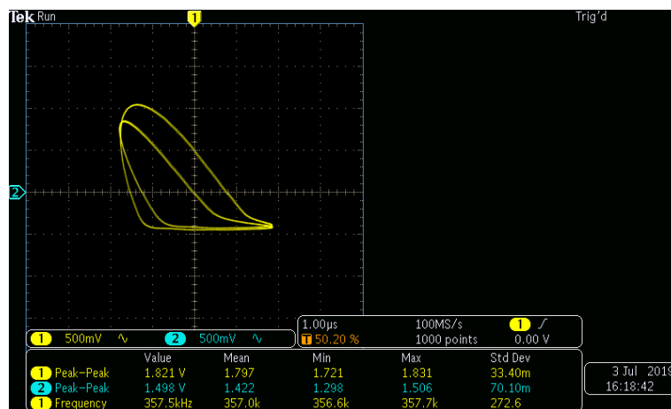
Slika 3.8: X-Y prikaz napona na diodi i ulaznog napona od 1.84 V sa zavojnicom induktiviteta 2/3 mH.
