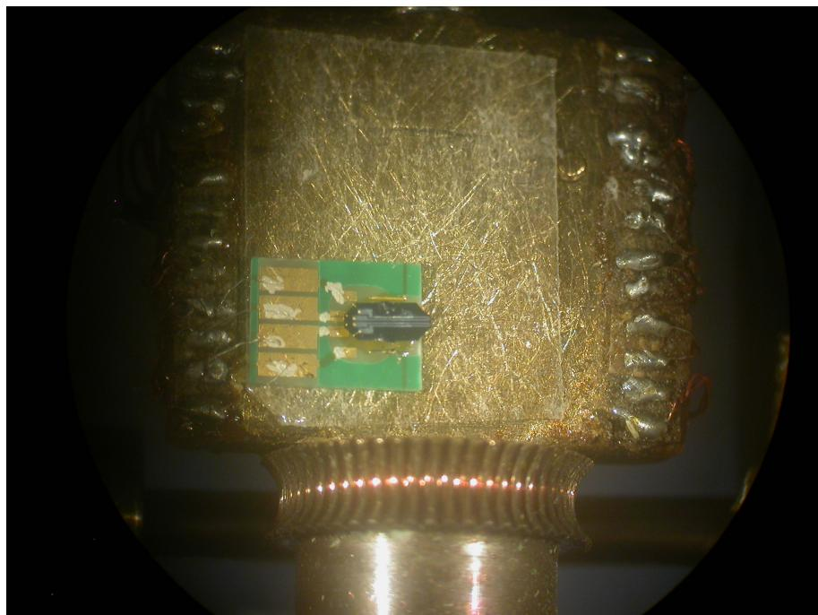
Slika 7.15: Na slici je prikazana poluga na kojoj se nalazi pločica sa piezoleverom. Na pločici se nalaze 4 kontakta te dva piezolevera koji su spojeni u Wheatstoneov most. Na jednom od piezolevera se nalazi uzorak YBCO monokristala zalijepljen na piezolever na ravninu s Millerovim indeksima (1,1,2). Poluga s uzorkom se može precizno rotirati unutar magnetskog polja.
