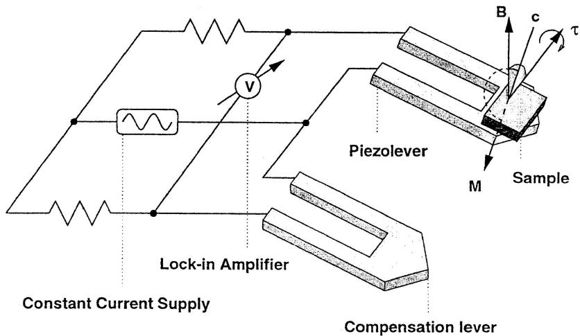
Slika 7.16: Na slici je prikazan shematski spoj Wheatstoneovog mosta s dva piezolevera. Na jednom od piezolevera je zalipljen uzorak YBCO monokristala. Magnetizacijom YBCO monokristala u magnetskom polju nastaje moment sile koji zakreće i deformira uzorak. Pomoću Wheatstonovog mosta s dva piezolevera, jednim s uzorkom i jednim bez, nakon kalibracije, dobiva se samo električni signal koji odgovara deformaciji piezolevera zbog magnetizacije YBCO monokristala. Slika je preuzeta iz [2].
