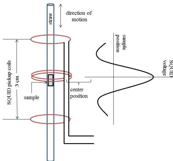
Slika 7.14: Na slici je prikazan shematski prikaz magnetskih mjerena pomoću SQUID metode. Uzorak je pričvršćen na polugu koja se tijekom mjerena giba između SQUID-ova. Cijeli postav se nalazi u kriostatu, u magnetskom polju koje je usmjereno u smjeru gibanja uzorka.
