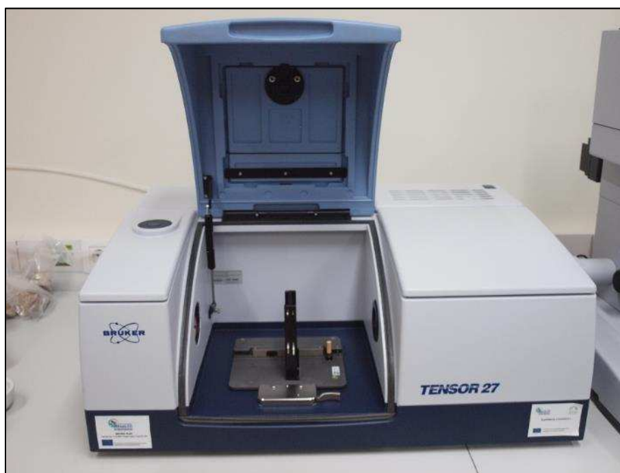
Slika 11. FT-IR spektrometar Bruker Tensor 27 u Centru za Istraživanje materijala Istarske županije METRIS
