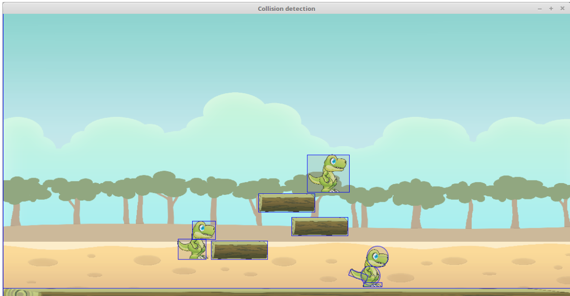
Slika 6.5: Prikaz efekta korištenja više b2Shape objekata
