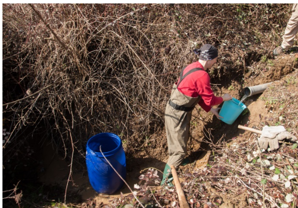
Slika 25. Mjerenje protoka na ponoru (P)
