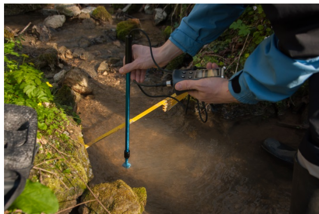
Slika 26. Mjerenje brzine toka na izvoru (I2)
