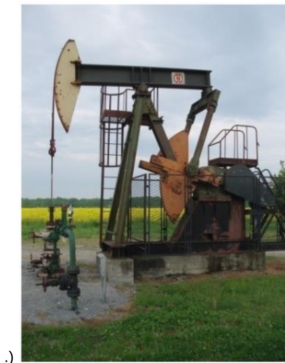
Slika 6.: Naftna bušotina s dubinskom sisaljkom
