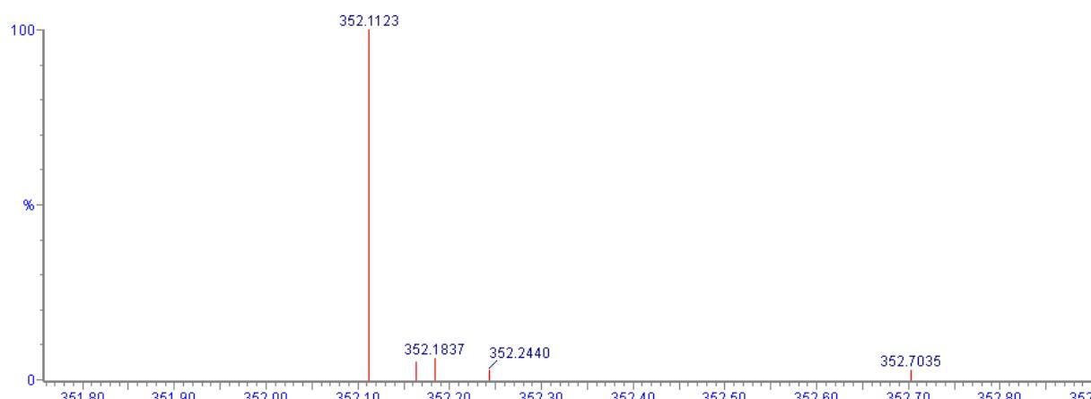
Slika D56. Spektar masa MS/MS i bodovna tablica elementne analize rosuvastatina D.1 za  $m/z$  352,1123. U bodovnoj tablici crvenom bojom je označen odabrani najvjerojatniji rezultat dobiven pretragom pomoću izračuna točne mase i usporedbe specifičnih izotopa.
