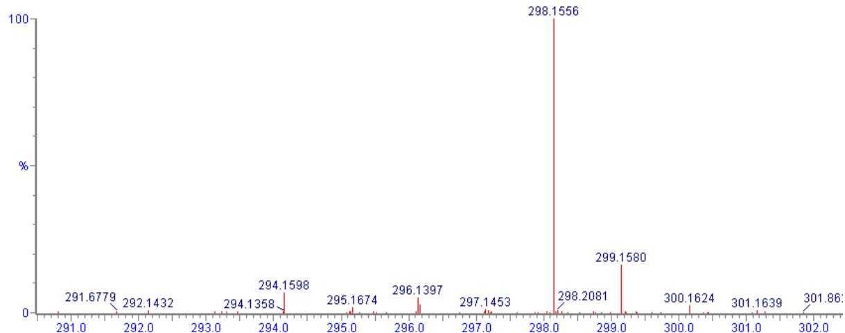
Slika D7. Spektar masa MS/MS i bodovna tablica elementne analize rosuvastatina A za  $m/z$  298,1554. U bodovnoj tablici crvenom bojom je označen odabrani najvjerojatniji rezultat dobiven pretragom pomoću izračuna točne mase i usporedbe specifičnih izotopa.
