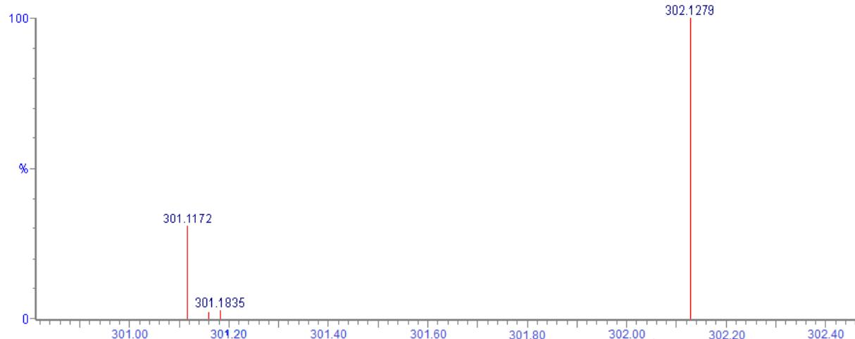
Slika D57. Spektar masa MS/MS i bodovna tablica elementne analize rosuvastatina D.1 za  $m/z$  302,1279. U bodovnoj tablici crvenom bojom je označen odabrani najvjerojatniji rezultat dobiven pretragom pomoću izračuna točne mase i usporedbe specifičnih izotopa.
