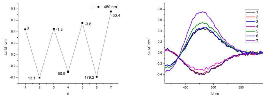
**Slika 70.** Pokus reverzibilnosti kiroptičke inverzije spoja **B2b**. Na lijevom grafu je prikazano okretanje (engl. *switching*) ferocena, brojevi pored svakog dodatka su suvišak TFA ( $n(\text{TFA}) - n(\text{DIPEA})/\text{mM}$ ). Desni graf prikazuje spektre iz kojih je generiran lijevi graf.
