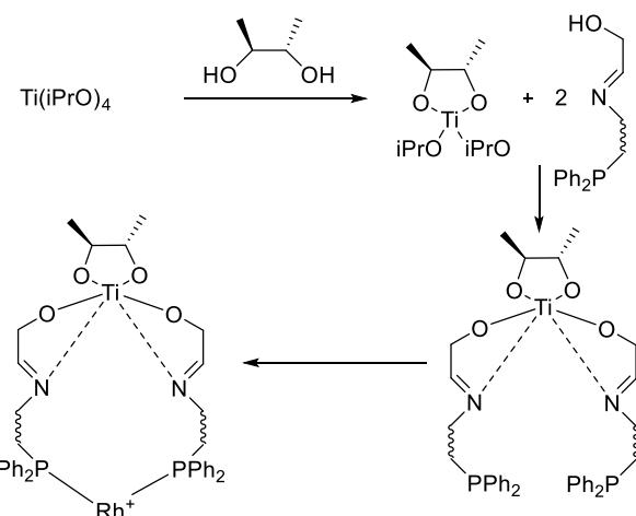
**Slika 23.** Shema konstrukcije liganada s Ti kao strukturnim i Rh kao katalitičkim metalom
