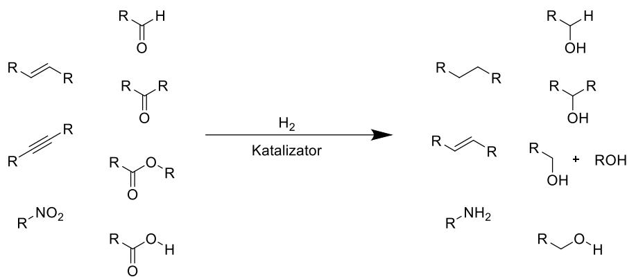
**Slika 2.** Klasični supstrati reakcije hidrogeniranja i njihovi produkti.
