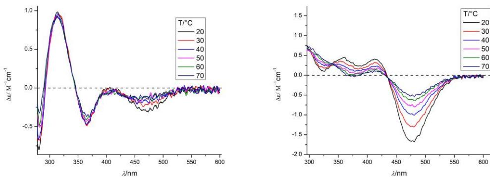
**Slika 71.** Temperaturna mjerena za spoj **B2b** s 8 ekvivalentima TFA (lijevo) i u suvišku TFA ( $c = 0.13 \text{ M}$ ) (desno). Oba mjerena su provedena pri približnoj koncentraciji  $c(\mathbf{B2b}) \approx 2 \text{ mM}$ .
