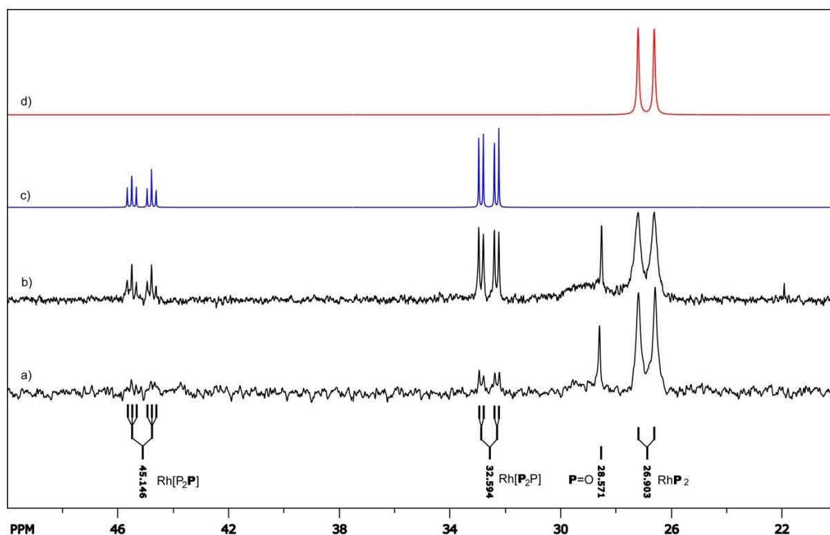
**Slika 47.** Usporedba  $^{31}\text{P}$  NMR spektara kompleksa  $[\text{Rh}(\text{COD})(\text{Tph}-\text{cyh}-\text{mP})_2](\text{BF}_4)$ , (21Rh). Eksperimentalni  $^{31}\text{P}$  NMR spektar ( $\text{CDCl}_3$ ): (a) pri  $c = 4$  mM i (b)  $c = 18$  mM. Simulacija  $^{31}\text{P}$  NMR spektra: (c)  $\text{A}_2\text{BX}$  spin sustav za  $\text{RhL}_3$  vrstu i (d)  $\text{A}_2\text{X}$  spin sustav za  $\text{RhL}_2$  vrstu. Za detalje vidi eksperimentalni dio 3.8.
