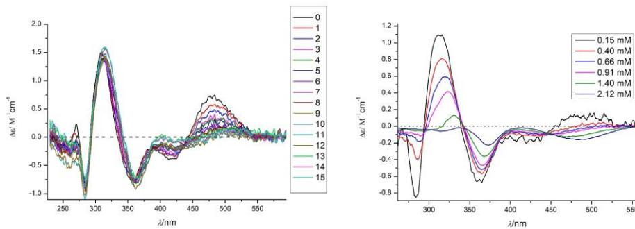
**Slika 69.** Lijevo - Dodavanje po jedan ekvivalent TFA u otopinu **B2b** koncentracije  $c_2 \approx 0.15 \text{ mM}$ . Brojevi u legendi su broj dodanih ekvivalenta, 0 je otopina čistog spoja **B2b**. Desno - Pokus razrjeđivanja smjese **B2b**/TFA (1/6) u DKM.
