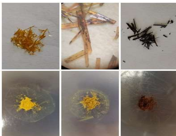
Slika 16. Prikaz promjene boje i transformacije [\text{MoO}_2\text{L}^1(\text{MeOH})] u [\text{MoO}_2\text{L}^1]_n stajanjem na zraku (prvi stupac – neto sintetizirani mononuklearni spoj; drugi stupac – početak polimerizacije; zadnji stupac – polimerizirani spoj).
