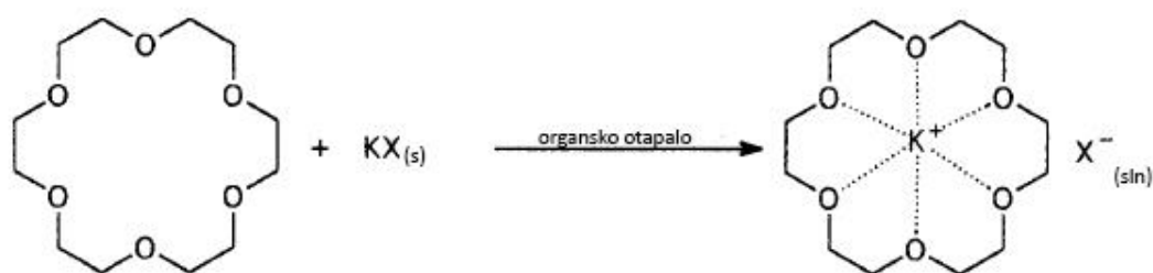
Slika 1. Vezanje alkalijskih (kalijevih) kationa pomoću krunastih etera u organskom otapalu
