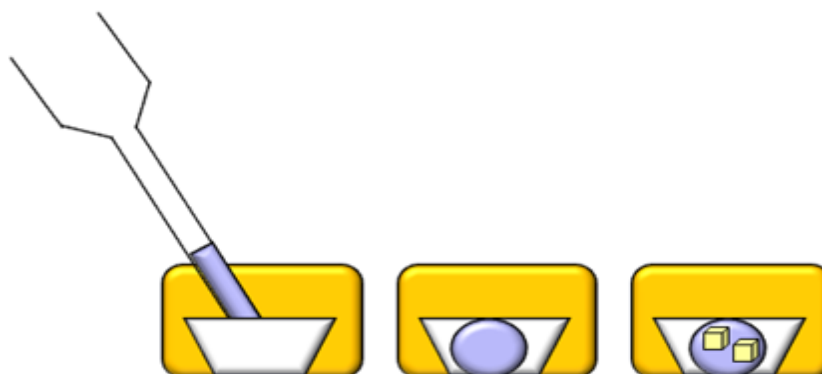
Slika 3. Microbatch metoda. Mala kapljica koja sadrži protein i kristalizacijsku otopinu u prezasićenim uvjetima smještena je ispod ulja kako bi se spriječilo isparavanje uzorka. 11
