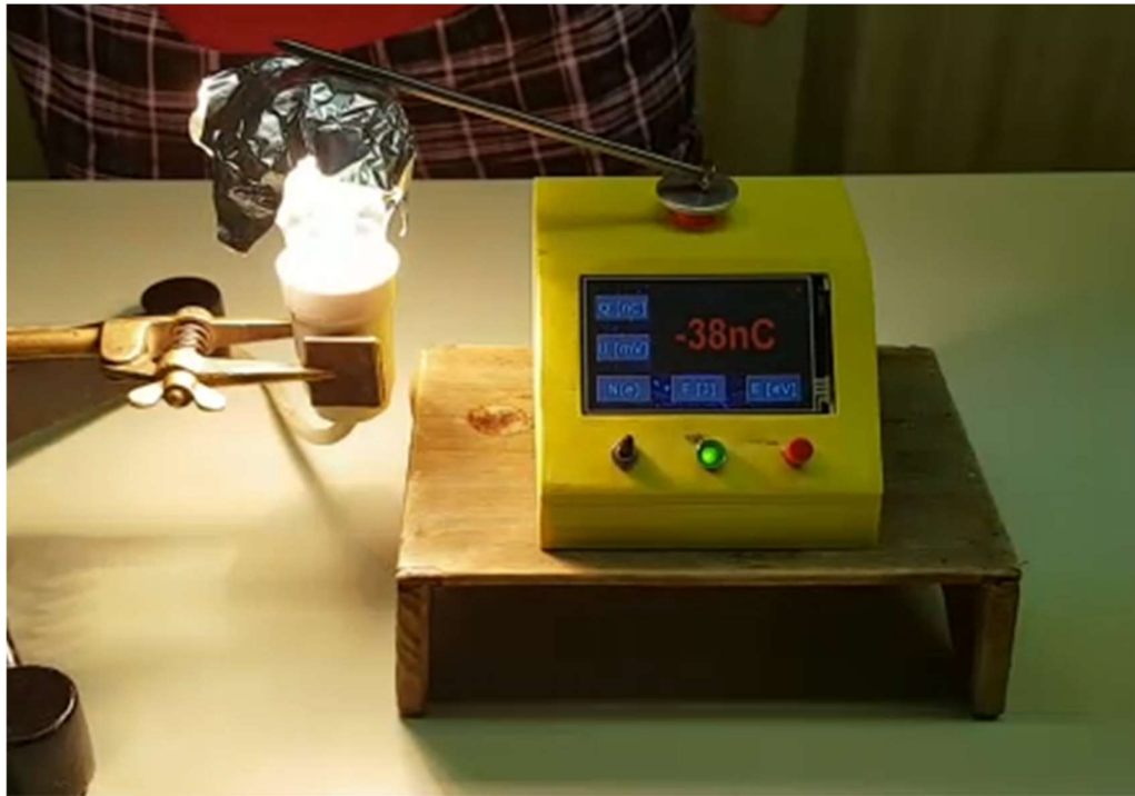
Slika 41 Postav pokusa "Termoelektronska emisija"
