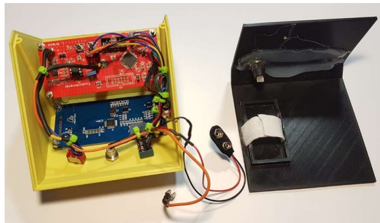
Slika 32 Izgled unutrašnjosti kulonmetra nakon 7. koraka
