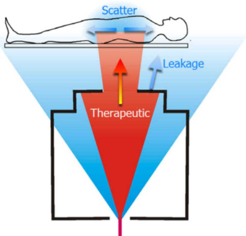
Slika 2.1: Shematski prikaz ozračivanja zaluštalim zračenjem. Crvenom bojom označen je primarni snop, a plavom bojom zaluštalo zračenje. Preuzeto iz [4]
