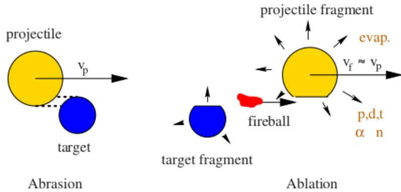
Slika 2.5: Ilustracija abrazijsko-ablacijskog modela perifernih sudara na visokim energijama. Preuzeto iz [3]
