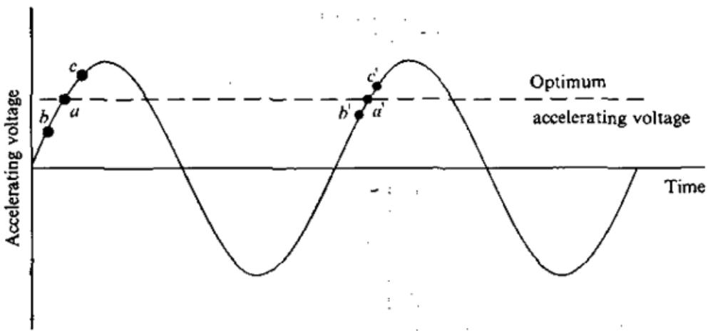
Slika 4.3: Fazna stabilnost linearnog akceleratora. Preuzeto iz [1]
