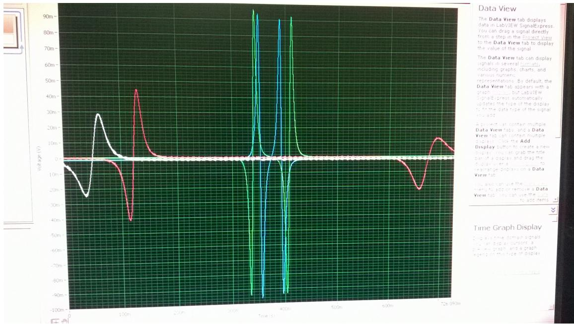
Slika 2.5: Graf ovisnosti induciranih napona o vremenu na četiri zavojnice.
