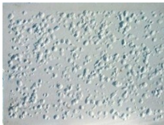
(b) Tragovi tuče na ploči
