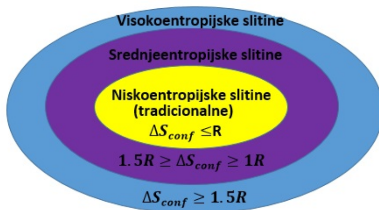
Slika 3.2: Shematski prikaz podjele slitina s obzirom na konfiguracijsku entropiju [5].
