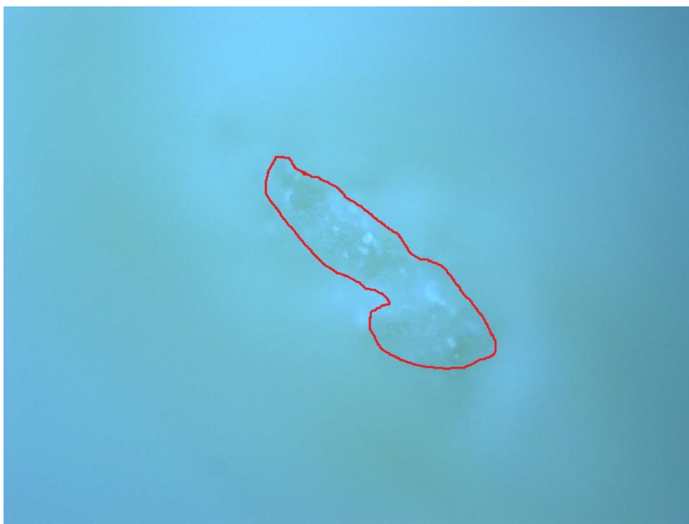
Slika 12.1. Krater korišten za fotokatalizu RB-a na dubini od 750 \mu\text{m} (dno kratera)
