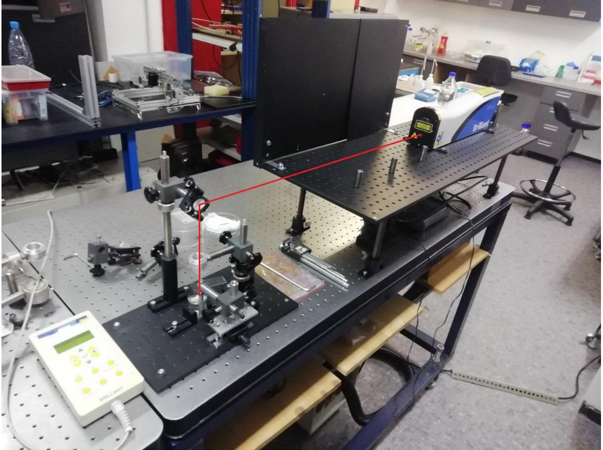
Slika 4 Eksperimentalni postav laserske ablacije u tekućini
