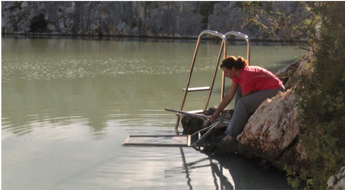
Slika 10. Uzorkovanje površinskog mikrosloja za vrijeme holomiksije Rogozničkog jezera (08.10.2016.) Garrett-ovom mrežom od nehrđajućeg čelika (Fotografija iz privatne kolekcije).
