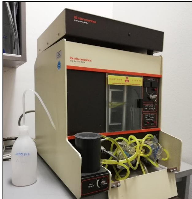
Slika 9 Sedigraf korišten pri granulometrijskoj analizi sedimenta
