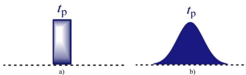
Slika 7. Sheme radiofrekvencijskih pulseva: a) tvrdi/kratki puls, b) meki/dugi puls.
