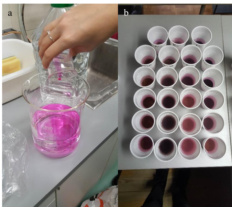
Slika 7. (a) Priprema otopine Rose Bengal za odvajanje živih od uginulih jedinki: 2 g Rose Bengal otapa se u 1 l destilirane vode, (b) tretirani uzorci sedimenta s Rose Bengal otopinom.
