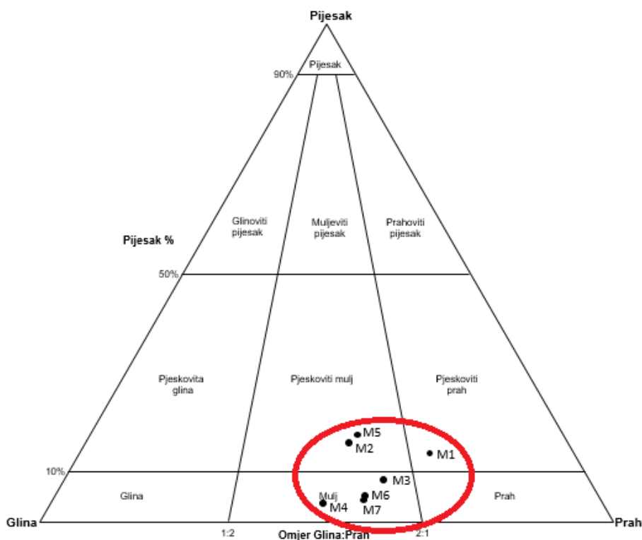
Slika 13. Granulometrijski sastav sedimenata svih uzoraka u trokomponentnom dijagramu pijeska praha i gline prema Folku (1954)
