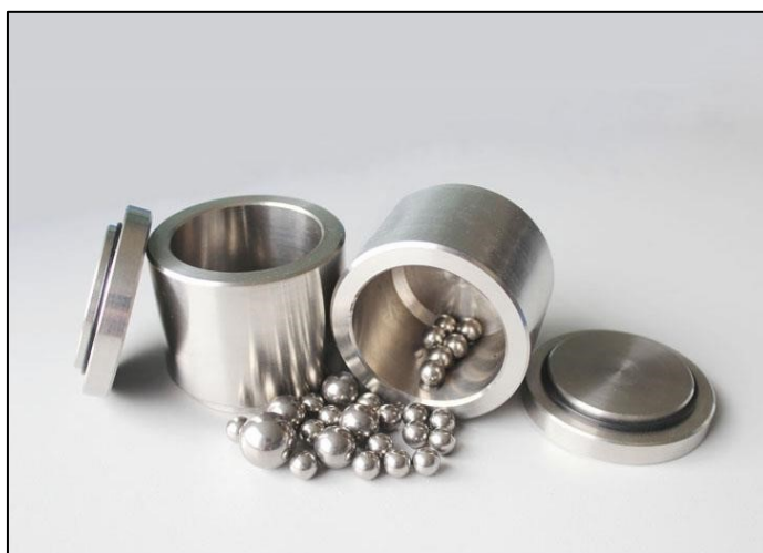
Slika 12. Posudice za mljevenje i kuglice od nehrđajućeg čelika 36
