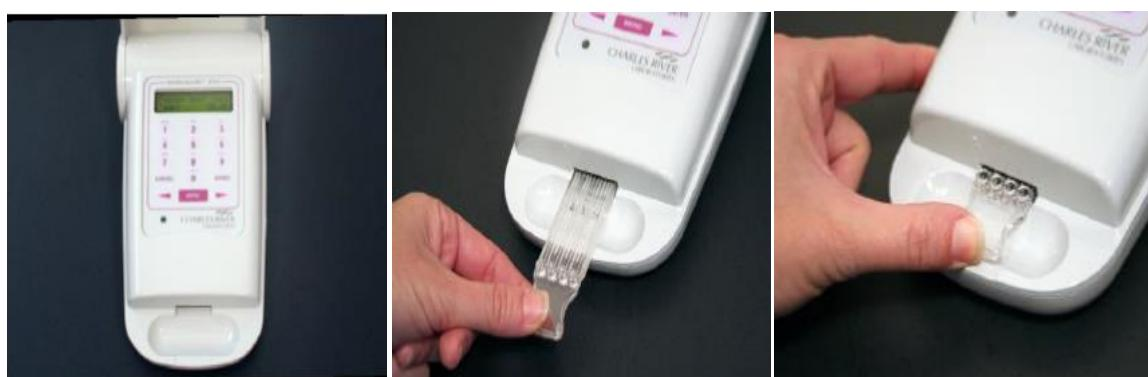
**Slika 6.** Prikaz određivanja endotoksina pomoću uređaja PTS.
